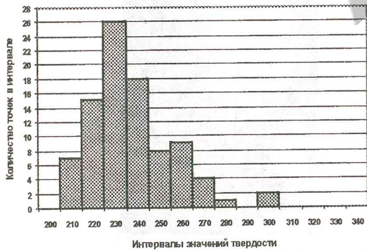
Рисунок 5 – Разбросы значений толщин стенок и твердости по трубам:
