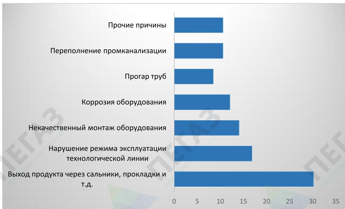
Рисунок 3. Причины аварий на открытых технологических установках
